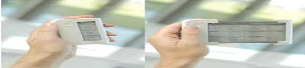
그림 3.16 필립스 사의 두루마기형 디스플레이(Rollable Display)
