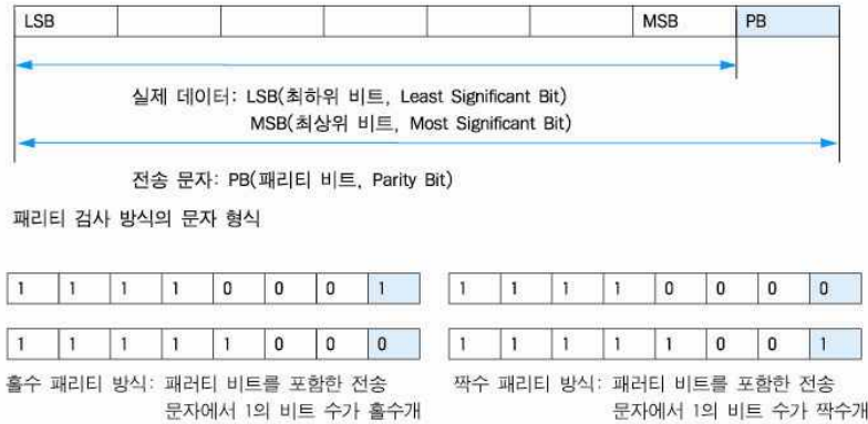
그림 4-21 패리티 비트 검사 방식의 전송 단위 형식과 예 그림 4.21 패리티 비트 검사 방식의 전송 단위 형식과 예
