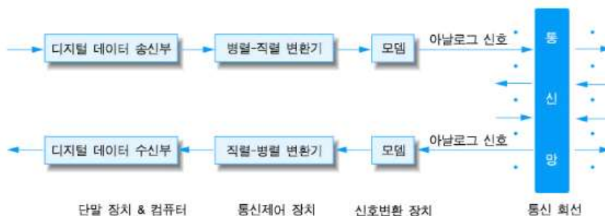
그림 2.7 신호 변환 장치를 이용한 데이터 통신과정
