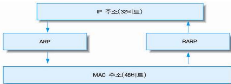
[그림 7-17] ARP와 RARP의 기능 그림 7.14 ARP와 RARP의 기능
