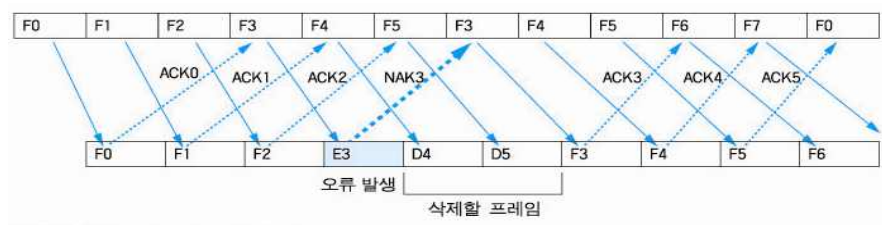
그림 4-18 Go-Back N ARQ 방식 그림 4.18 GO-Back N ARQ 방식
