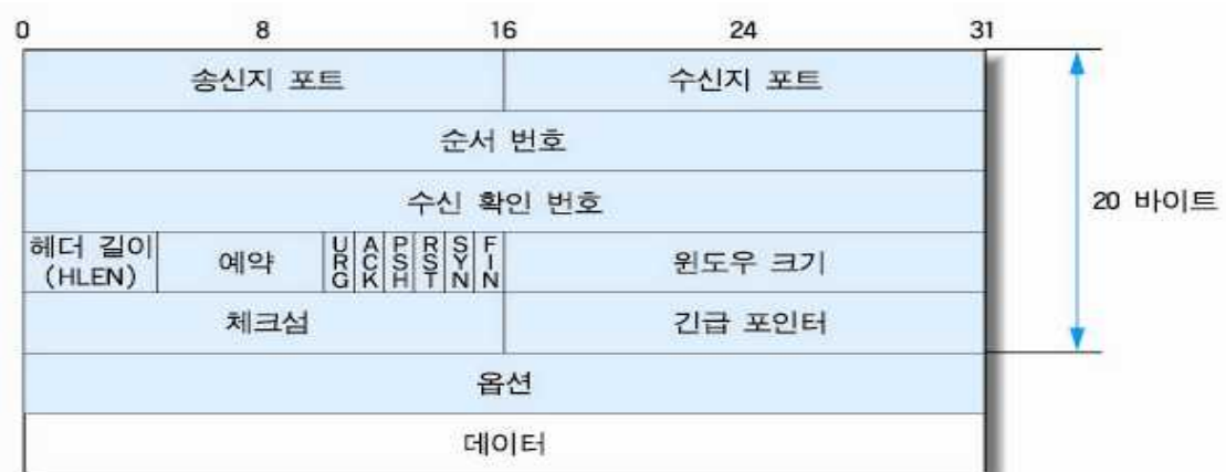
[그림 7-20] TCP의 세그먼트 형식 그림 7.17 TCP의 세그먼트 형식
